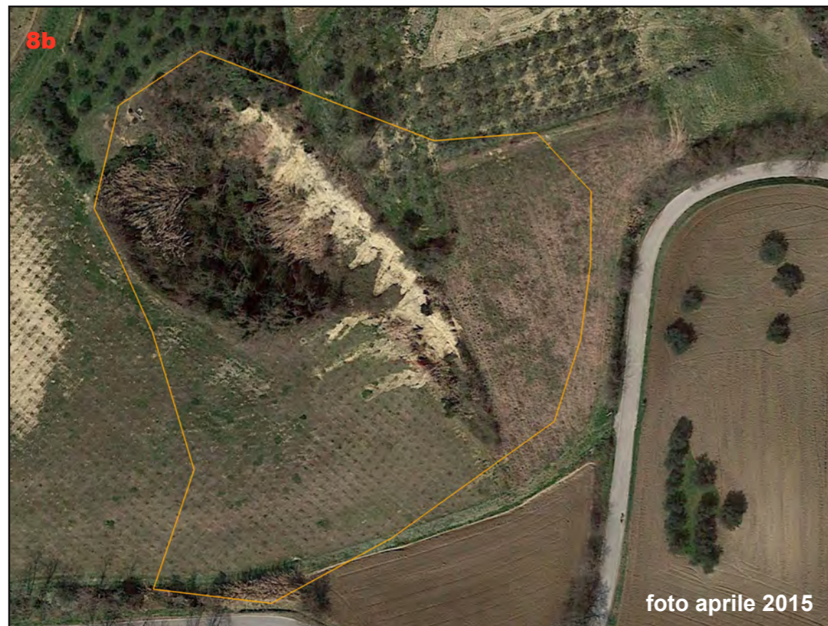
Foto 2 - foto aerea dell'aprile 2015 dell'area Montalbano b; si evidenzia la presenza di alcuni smottamenti sulla scarpata di ex-cava.
